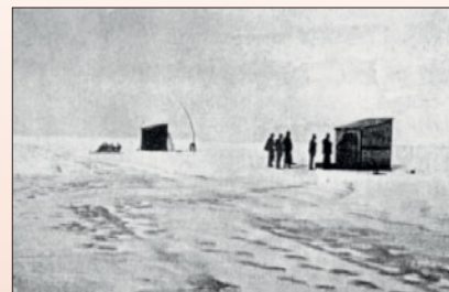
76. ábra. Mérő-állomás a Balaton jégén. A báró Eötvös Lóránd-féle csavaros mérleggel mértük a föld belsejében a sűrűbb és kevésbé sűrű tömegek elhelyezkedését. Balra a lakósátor; jobbra a műszersátor. (Szerző fényképe.)
